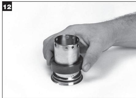
スリーブ内側O-リングを付随するシリコングリースで潤滑し、スリーブ内側のO-リングの溝にはめ込みます。スリーブ回転O-リングを潤滑し、スリーブ外側の溝にはめ込みます。回転環リングをスリーブ上で滑らせ、スリーブ駆動タブと回転シールリングのスロットを底に達するまで合わせます。
