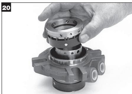
回転環リングとロックリングを押さえながら、ロックリングと回転アセンブリを慎重に持ち上げます。これで回転環リングが落ちるのを防ぐことができます。駆動タブが回転環リングのスロットと位置合わせされていることを確認してください。ロックリングアセンブリを反転させ、スリーブ上を滑らせ、1/4ポイントセットスクリューを小さい穴に合わせ、カップポイントセットスクリューを大きい穴に合わせます。回転環リングを指で持ち、回転ユニットが静止環リングに接触するまで、ロックリング上を静かに押し下げます。
