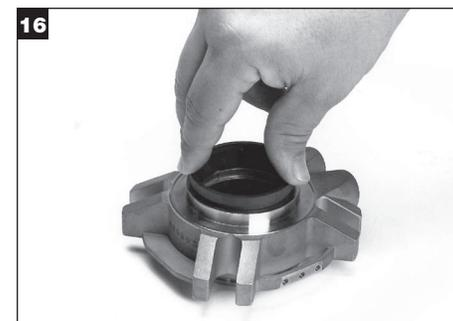
グランドアセンブリを反転させてください。もうひとつの静止環リングをグランドのインボード側に滑らせ、O-リングを超えて流路の駆動クリップと係合するまで静かに押し込みます。駆動クリップが静止スロットと位置合わせされていることを確認してください。このアセンブリは簡単に(軸方向に)動かすことができます。
