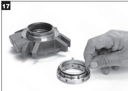
ロックリングO-リングを潤滑し、ロックリングO-リングの溝に入れます。ロックリングに適切なスクリューが入っていることを確認してください。カップポイントセットスクリュー3個、ハイブリッドドッグ/カップポイントセットスクリュー3個が、ロックリングの大きな穴に交互に入っているはずで、(2.50インチ及び60 mm以上のサイズは、カップポイントセットスクリューは6個) ロックリングの各穴にスプリングをはめます。各スプリングの底に少量のシリコングリースを塗ります。これでスプリングが穴の中で固定されます。
