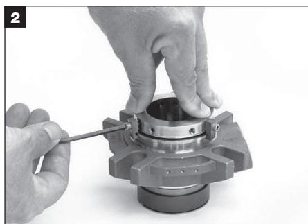
ロックリング側を上にしてシールを平坦な表面に置きます。センタリングクリップをすべて外します。
