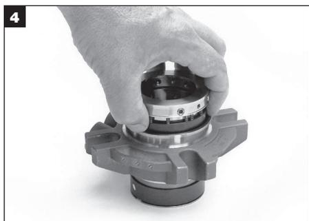
回転リングとロックリングを押しえながら、ロックリングと回転アセンブリを慎重に持ち上げます。これで回転リングが落ちるのを防ぐことができます。回転リング側を上に向けて、ロックリングアセンブリを置きます。
