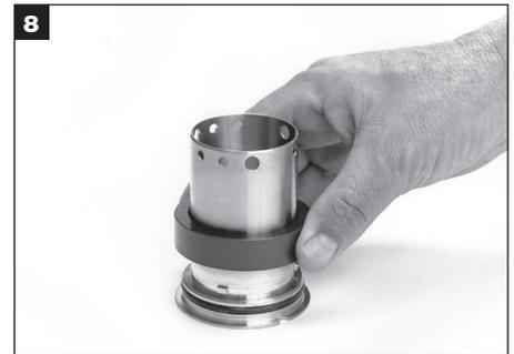
8 回転リングと2個のO-リングをスリーブから外します。
