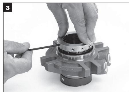
ロックリングを押し付けたままセットスクリューを全てスリーブから外します。
