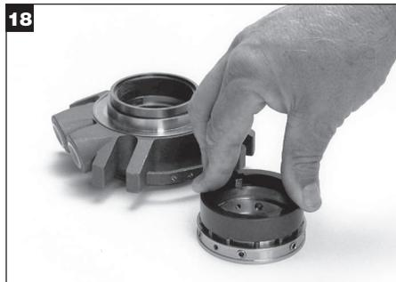
アウトボード回転環リングを、O-リングを通過するまでロックリング上で滑らせ、駆動タブと回転スロットを合わせます。回転環リングを押し込み、スプリングを圧縮させ、回転環リングが自由に動くことを確認します。静止環リングと回転環リングを無塵布で拭きます。
