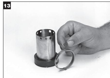
2個の駆動クリップが取り付けられていない場合は、流路のスロットに2個の駆動クリップをはめ込んでください。注:2.50インチおよび60 mm以上のサイズでは4個の駆動クリップが付いています。
